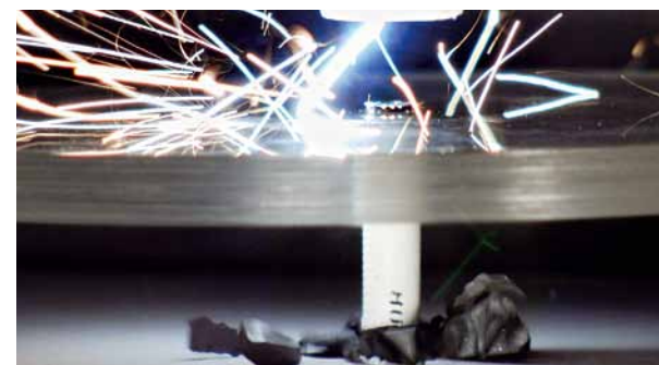
Obr. 9a. Elektromagnetický impulz 45 kV, 40 kA, 350 ns, 630 J.
