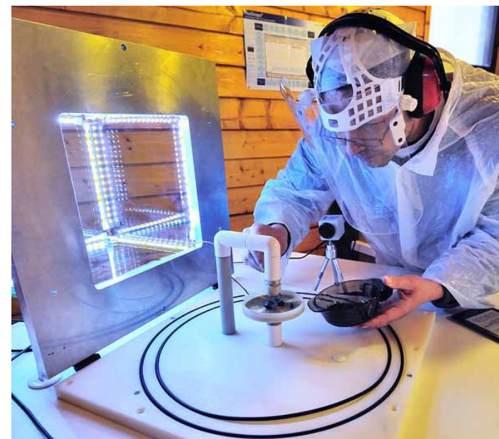
Obr. 8b. Príprava vzorky pred aplikáciou impulzného mag- netického poľa.
